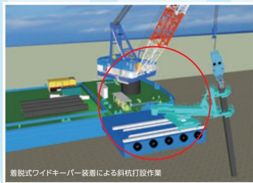
着脱式ワイドキーパー装着による斜杭打設作業
